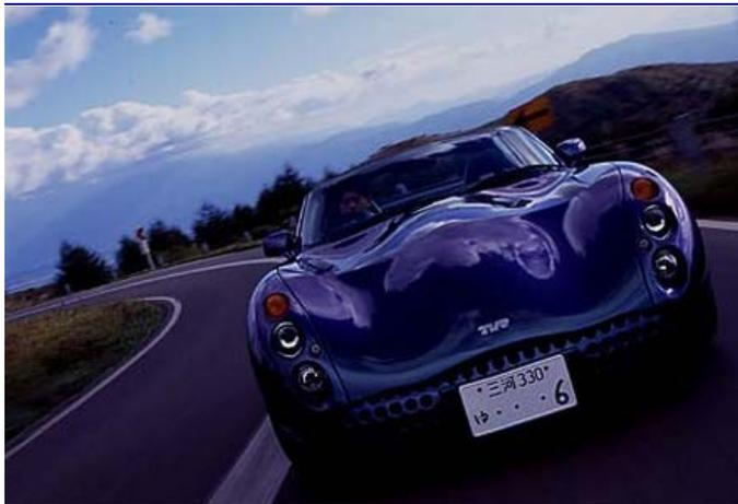
【スペック】全長×全幅×全高=4235×1720×1200mm/ホイールベース=2364mm/車重=1100kg/駆動方式=FR/4リッター直6DOHC24バルブ(360ps/7000rpm、42.9kgm/5250rpm)/車両本体価格=948.0万円(テスト車=1027.0万円)リフレックスペイント(58.0万円)/フロアマット(3.0万円)/18インチホイール(18.0万円)
